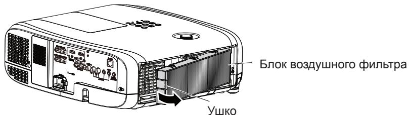
**3) Установите дополнительный запасной фильтр (Модель: ET-RFV400) в проектор.**
