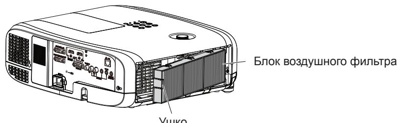
**4) Установите крышку воздушного фильтра в проектор.**
